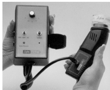
Fig. nr. 11-2. Mini pompă ZEFON, adaptată Casetei AIR-O-CELL
